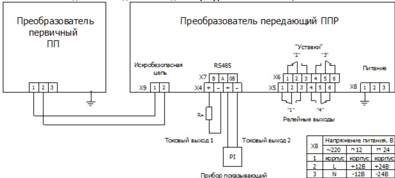
Рис. 4. Схема подключения датчика-индикатора уровня РИС 101М1, РИС 101М1И
